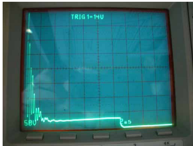
Abb. 11 Sich addierende RE-Impulse am Beginn des Signals bei 1 Pulsfrequenz
