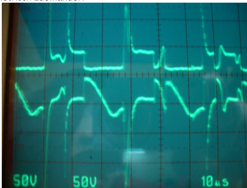
Abb. 34 (06.01.2007 - 14:39) Signale an den Anschlussleitungen der Glühlampe bei max. Umwandlung
