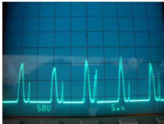
Abb. 38 (05.31.2007 - 15:52) 16" ECD - 2 Steuerspulen mit 2 Frequenzen
