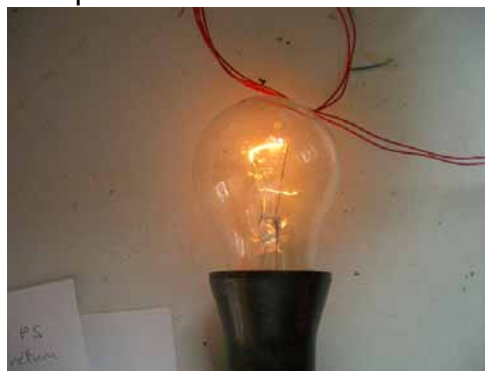
Abb. 26 Helligkeit einer 100 W Glühlampe mit 2 Steuerspulen
