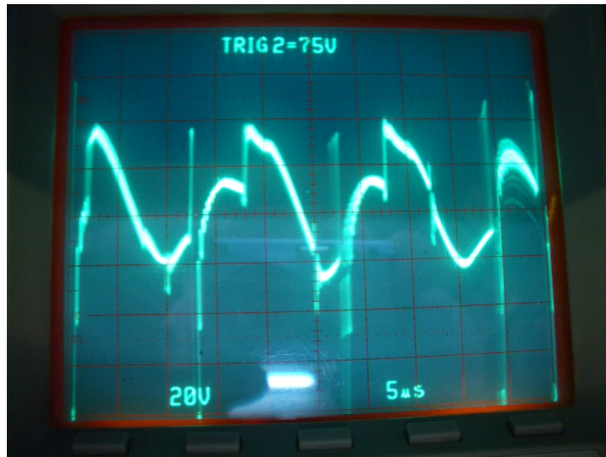
Abb. 41 (06.02.2007 - 8:56) 16"-ECD - 3 Steuerpulen, parallel geschaltet, mit 2 Frequenzen - nahezu vollständige Umwandlung
